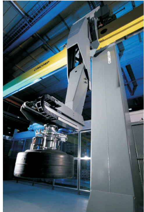
Kuva hankkeessa kehitetystä lineaaribotista. Lineaarirobotti tehostaa rengasaihoiden las- taamista paistoprasseihin.
